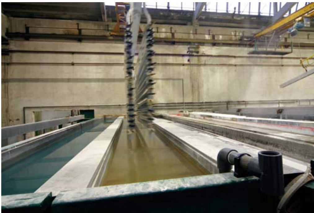
8 - Le vasche dedicate al ciclo di sgrassaggio, risciacquo e passivazione con prodotti "chrome free".
