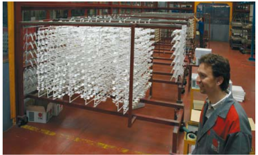
8 – La preparación de los bastidores de la instalación de pintura se efectúa fuera de línea.
