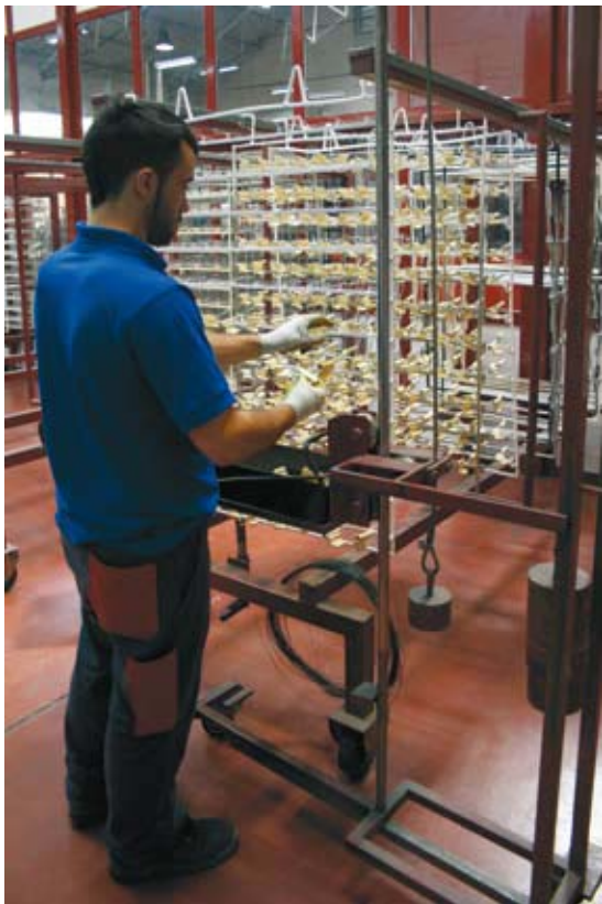
8 – La preparación de los bastidores de la instalación de pintura se efectúa fuera de línea.
