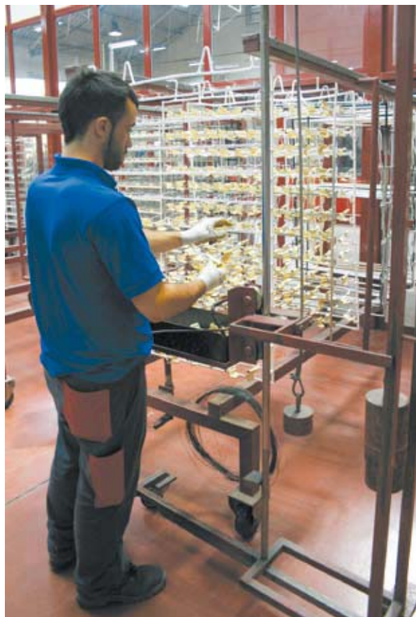
7 - Un cesto di pezzi trattati, pronti per essere caricati sulle bilancelle dell'impianto di verniciatura a polveri. 7 - A basket of treated pieces, ready to be loaded onto the racks of the powder coating plant.
