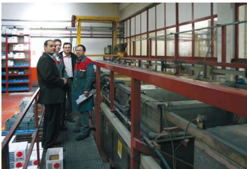
3 - Una vista della linea di pretrattamento a vasche. Conta di 8 fasi.
