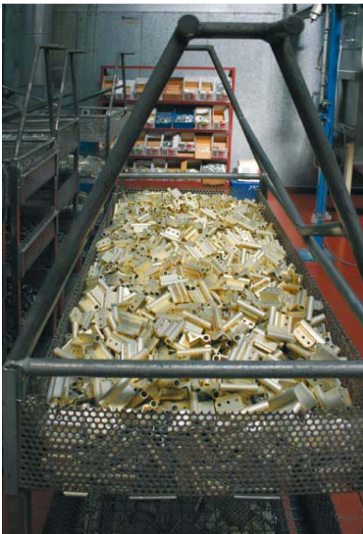
7 - Un cesto di pezzi trattati, pronti per essere caricati sulle bilancelle dell'impianto di verniciatura a polveri. 7 - A basket of treated pieces, ready to be loaded onto the racks of the powder coating plant.
