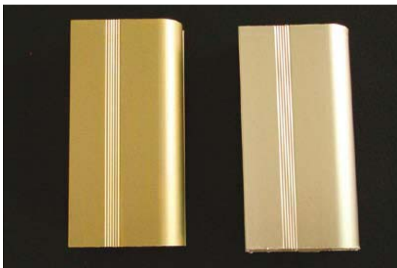
1 - Qui sopra, a sinistra, un manufatto cromatato, a destra un pezzo titanato.
